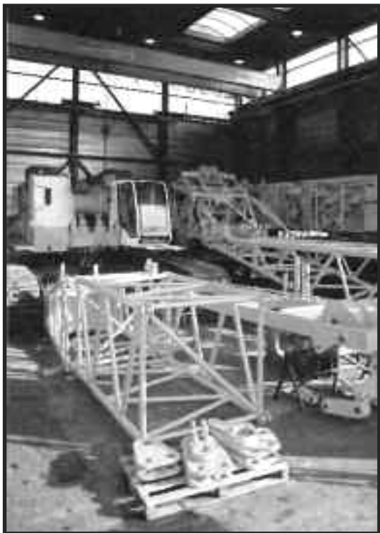
Pásový jeřáb podstupuje rekonstrukci v závodě Avezaat
