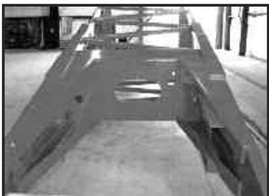
Základní část ramene pásového jeřábu Manitowoc 4100 podstupující opravu společností Wheco
