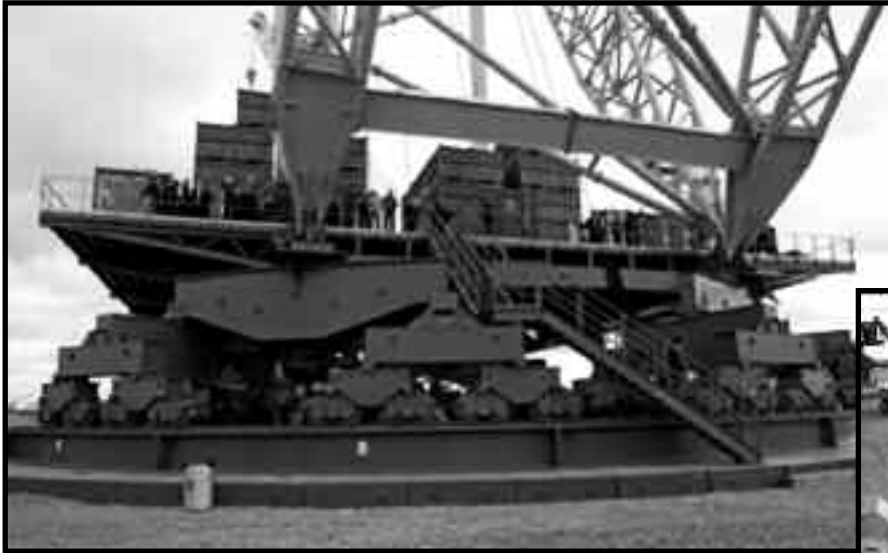
Točna má průměr 43,6 metrů a pojíždí po ní 96 kol po dvou kolejnicích
