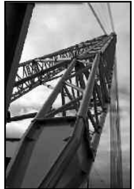
Jeřáb SGC 140 má nosnost 2820 tun s vyložním 50 metrů
