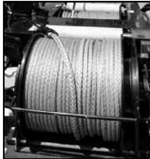
Syntetické lano Samson Rope K-100 navinuté ve více vrstvách.
