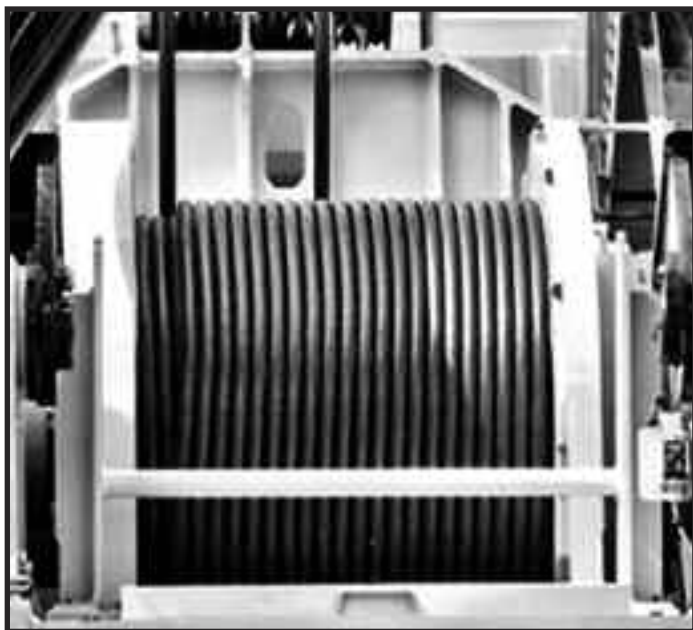
Správné navíjení na vícevrstvý buben
